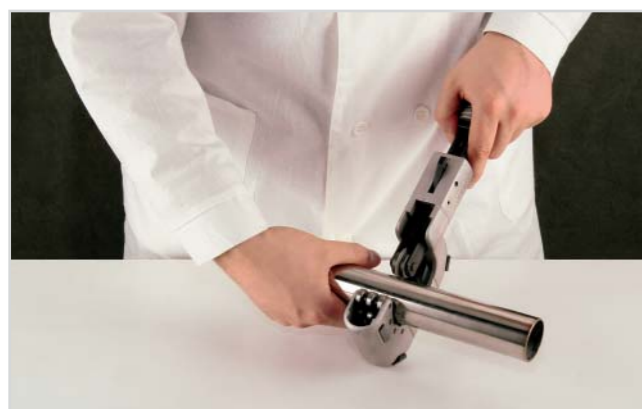
Рис. 10 — нарезка до необходимой длины
