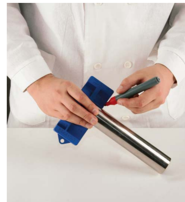
Рис. 12 — глубина введения и минимальное расстояние
